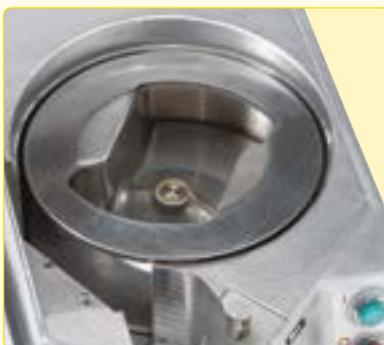
Der Spezialrotor führt die Kartoffeln optimal zum Schneidblock und sorgt für beste Form- und Schnittergebnisse.
